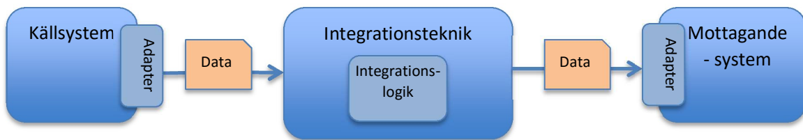
Figur 2: integrationsmönster händelsestyrd nav-arkitektur med adapter som del av källsystemet.
